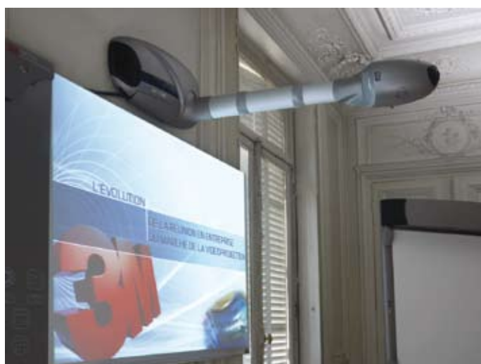
Le projecteur est intégré dans la partie supérieure d'un bras télescopique qui a le double avantage d'éviter au conférencier d'être ébloui par le flux lumineux et de supprimer les ombres. (3M)
